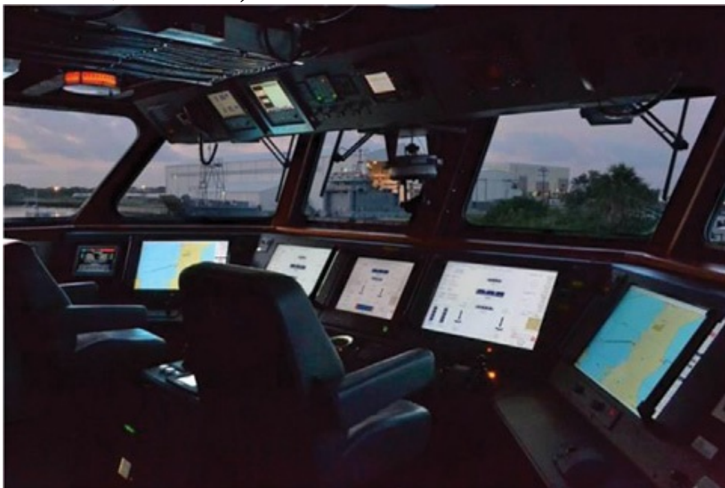
Moderno puente de mando en configuración «piloto-copiloto» con pantallas de muestra de los datos tomados por las ayudas a la navegación. El contacto directo del moderno marino con el exterior ha acabado siendo igual a cero.
